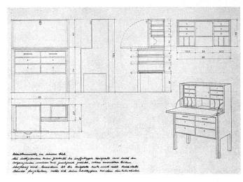
Abb. 9 Schreibsekretär, Konstruktion Tischlerplatten fourniert | Secrétaire en contreplaqué / Writing-desk, construction blockboard with veneer finish Ludwig Levy
