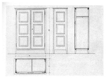
Abb. 8 Kleiderschrank, Konstruktion Rahmen mit Füllungen / Armoire; construction en chassis et panneaux | Wardrobe, frame construction Walter Bussinger with panels
