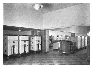
Speisetransportwagen mit elektrischem Triebwagen
