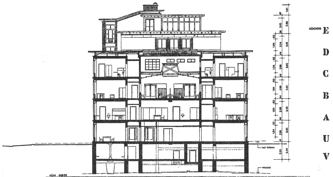
Querschnitt durch Südbau, Blick nordwärts 1 : 300
