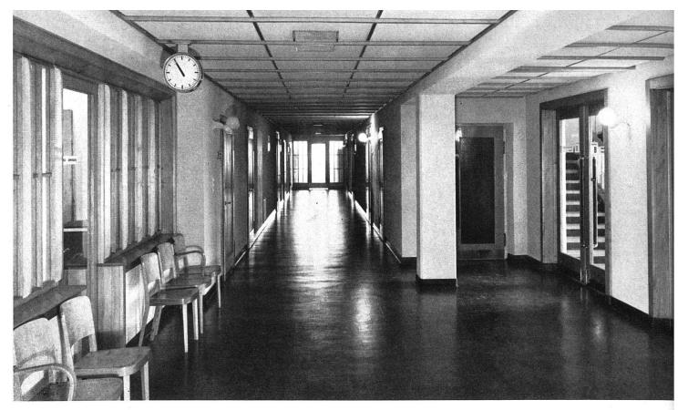
Abb. 45 Normalkorridor beim Anschluβ des zukünftigen Bettenhauses. Die Decken sind hier gegenüber der normalen Raumhöhe von 3,00 m 2.45 m als demontable Paneele (Pavatex mit Naturholzrahmen) herabgesetzt (Hohlraum für Leitungen, Verringerung des Nachhalls, räumk Kontrast zu den Zimmern). Bodenbelag aus Korkplatten
