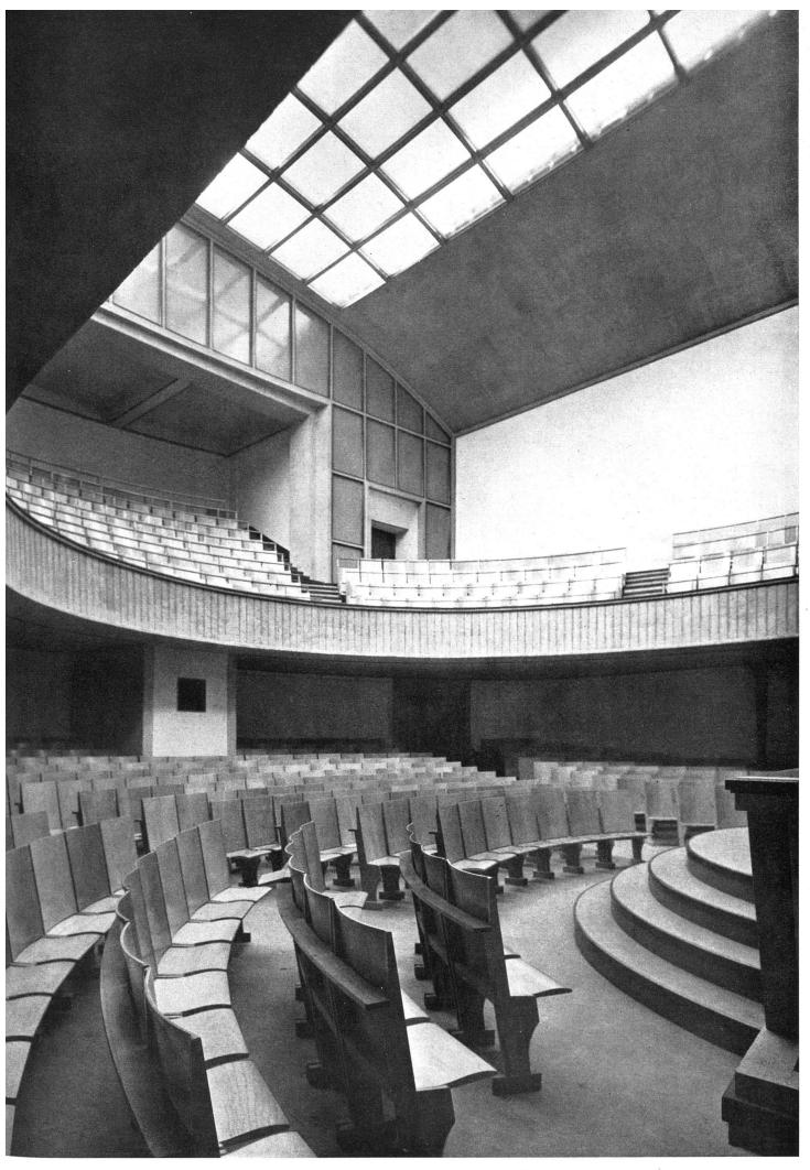
sur le parterre et le balcon. La balustrade est exécutée en béton apparent, les panneaux de recouvrement du mur de fond et du plajond sont en eplaqué (bois de hêtre)
