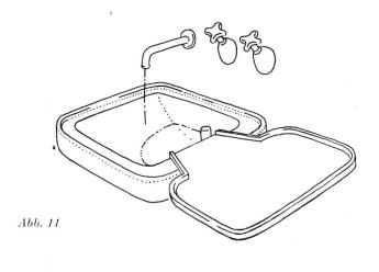
Die Disposition nach Abb. 11 sieht eine separate Abstellplatte in beliebigem Material vor. Dem Vorteil größerer Anpassungsfähigkeit steht der Nachteil des unsauberen Anschlusses der beiden Teile gegenüber. Als Ab- und Überlaufventil dient ein Standrohr, eine zwar saubere, aber etwas unpraktische Lösung. Der Wasserstrahl trifft im Sinne von Abb. 10 auf die geneigte Seitenwand des Beckens.
