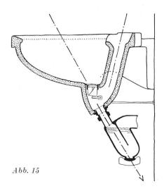
Durch Schrägstellung des Ablaufes (Abb. 15) und durch eine besondere Formung des Ventilkörpers konnten die Plätschergeräusche, die ein schwacher Strahl beim Hinunterrieseln in den Siphon verursachte und die durch den weit geöffneten Überlaufkanal hörbar waren, reduziert werden. Um den Anforderungen des Spitals so weit als möglich zu genügen, ging man auf Grund dieser Studien technisch noch einen Schritt weiter.
