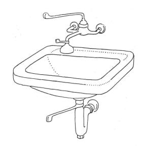
Beim Ärzte-Waschtisch (Abb. 4) sind Maßnahmen, die ein leichtes Reinhalten unterstützen, beachtenswert. Auf einen schlecht zugänglichen Überlauf wird verzichtet. Die Hahnenbatterie wird an die Wand verlegt, um den Toilettenkörper von Metallteilen freizuhalten.
