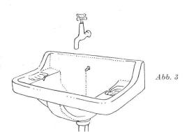
nis des Innenmaßes des Beckens zum Außenmaß der Toilette verschiebt sich zugunsten größerer Weite des Beckens. Eingeformte Seifenschalen sind leichter zu reinigen als solche in separaten Haltern.
