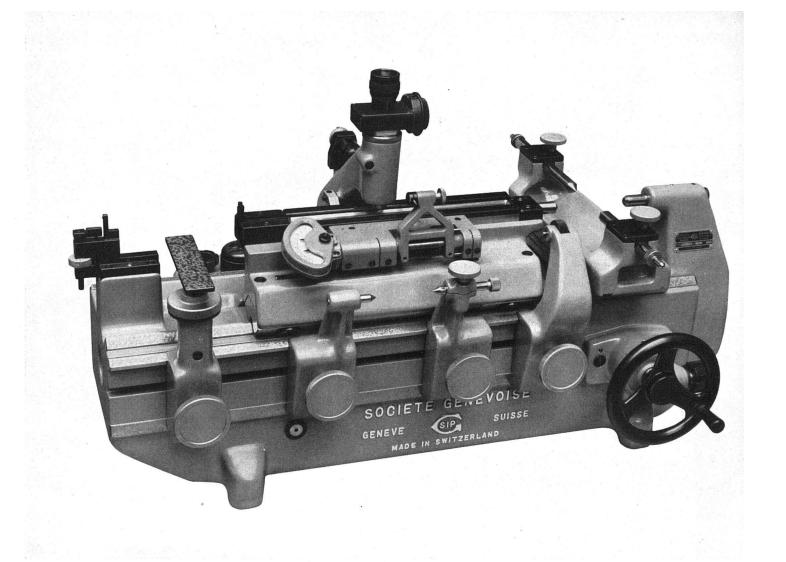
Genauigkeits-Meßmaschine für Werkstattlehren mit Meßbereich für Längenmessungen bis 250 mm und für Durchmessermessungen bis 10 (Länge des Apparates 830 mm). Konzentrierte Zusammenfassung aller Teile in einheitlichem Gestaltungswillen zu einem in sich geschlo Ganzen mit sorgfältigster, in gutem Sinne ingenieurmäßiger Detaildurchbildung. Société Genevoise d'Instruments de Physique
