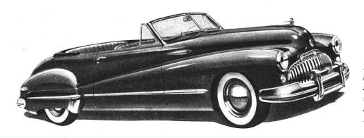
Buick-Cabriolet 1945. Ebenso einheitlicher Gestaltungswille, jedoch aus dem Zeichnerisch-Modischen entsprungen. Die über die Türe fortgesetzten Stromlinienkotflügel bedingen z.B. eine unnötige Komplizierung des Türproblems
