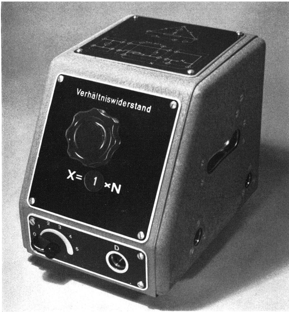
Verhältnis-Widerstand, mit sorgfältiger und differenzierter, dem technischen Zweck entsprechender Gestaltung der drei Schrifttafeln. Contraves AG., Zürich
