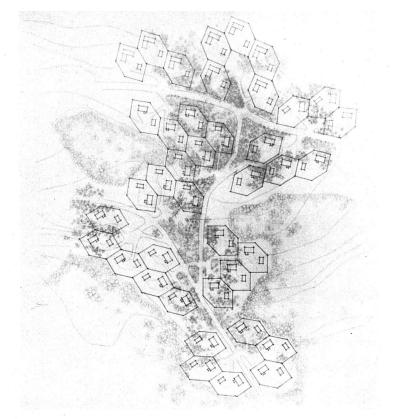
Abb. 7 Ein/amilienhäuser mit sechseckigen Grundstücken, die eine lockere Bebauung erleichtern
