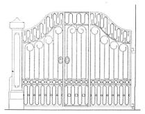
Abb. 1. Aufnahme eines Hoftores am Haus zum Merkur in Winterthur. Die Stäbe sind mit Doppellinien gezeichnet, wobei inbezug auf die Wirkung unklar bleibt, ob die Konturstärke zum Stab oder zum Zwischenraum gehört
