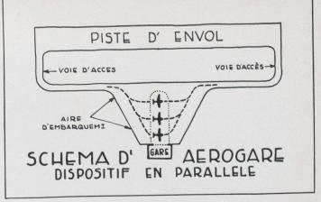
Fig. 1 Noter l'indépendance des voies de roulement des avions, qui ne se coupent pas entre elles.
