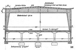
Abb. 7 Querschnitt 1:200 mit Pilzdecke für 1,5 t pro m² Nutzlast über Kellergeschoβ und genagelte Rahmenbinder über Erdgeschoβ. Spannweite ca. 17 m. Binderabstand 4,2 m
