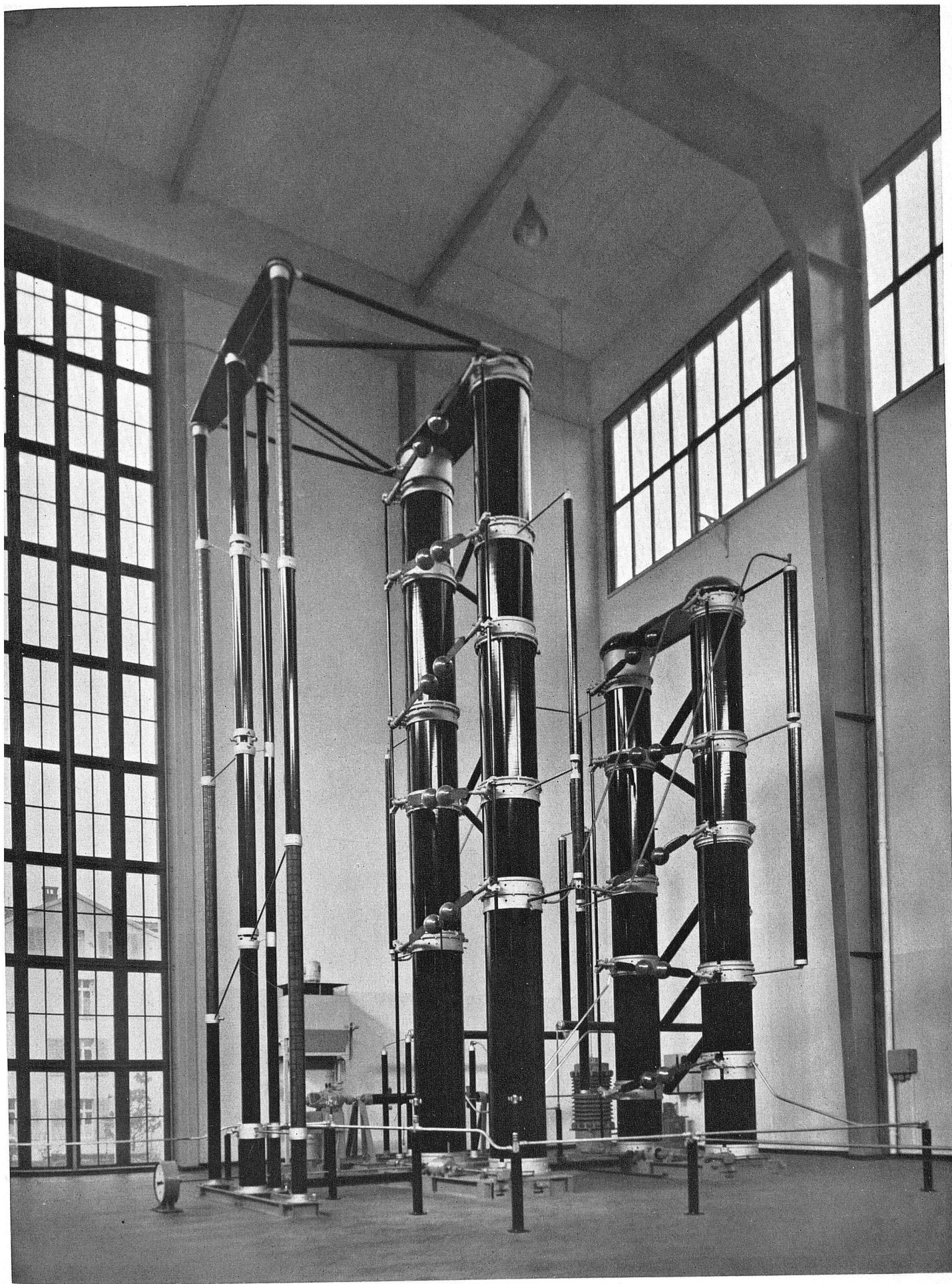
Stoßspannungs-Generator für 2,4 Millionen Volt
