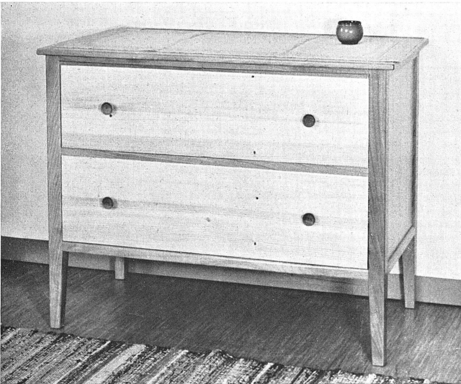
Abb. 7 Kommode. Die Verwendung von Hart- und Weichholz (Kirschbaum und Tanne) entspricht den unterschiedlichen Ansprüchen an Konstruktion und Füllflächen
