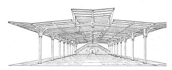
Eisenkonstruktion an der Fisch-Markthalle Hungford, London, mit B dach, 1835
