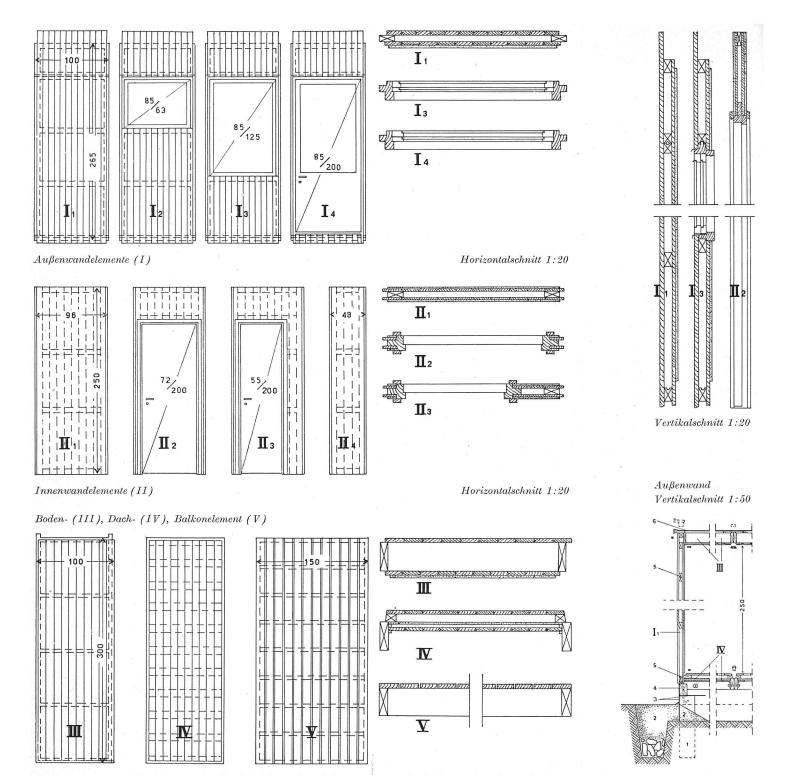
Die Bauelemente 1:50 Diese werden in ein leichtes Eisenskelett montiert und mit Spannschrauben fixiert
