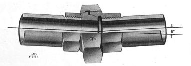
» Mac « Verschraubungen können auch in Verbindung mit Winkelstücken geliefert werden. Wie alle übrigen +6F+ Fittings, werden auch die » Mac « Verschraubungen vor Versand auf innern Wasserdruck geprüft.
