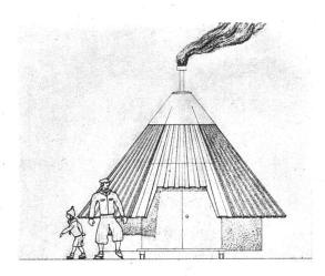
Wärmehütte an Schlittschuhplätzen. In der Form den Lappenhütten nachgeahmt, sind diese kleinen Holzbauten auf Schlittenkufen aufgebaut und können am Ende des Winters weggezogen werden. Maßstab 1:80.
