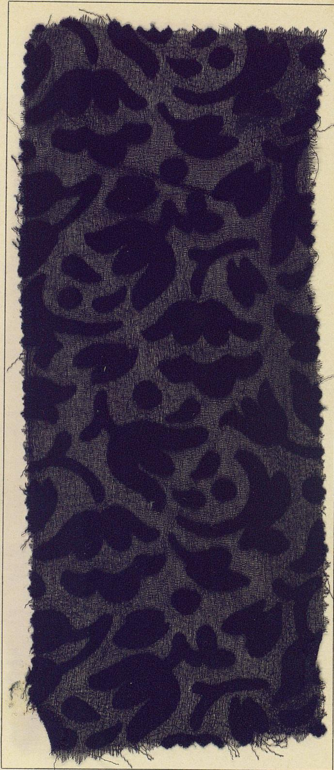
Devorant (Aetzdruck), hergestellt aus dem Gewebe «Peau de Pêche» der Firma Stehli & Co., Zürich. Das Gewebe besteht aus Azetat und Viscose. Der fassonierte Effekt wurde durch Herausätzen der Azetatseide erzielt, an den durchsichtigen Stellen ist nur die Viskose übriggeblieben.
