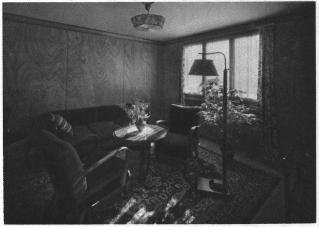
Wohnzimmer und Gang sind mit rohem, 16 mm starkem Fas-täfer ausgeschlagen, die Decken mit Pavatexplatten verkleidet. Ein Spezialkachelofen für Holzdauer-brand ist auch imstande, die an-
