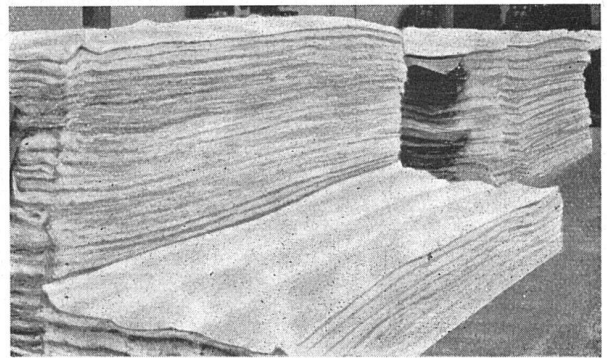
Glasseidematten hinter gelochten Gipsplatten zur Schalldämpfung an der Untersicht der Empore im Foyer des Kongressgebäudes Zürich
