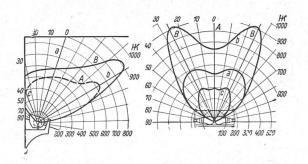
links: Lichtverteilung des Rinnenspiegels LSpJ25 für einen Lichtstrom von je 1000 Lumen in der Hauptebene. A = Schaulinie in der Hauptebene; B = Schaulinie  $25\,^{\circ}$  gegen die Hauptebene geneigt (vergl. auch Bild rechts)
