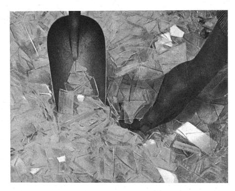
Glasscherben — das Ausgangsmaterial für die Herstellung von Glasseide
