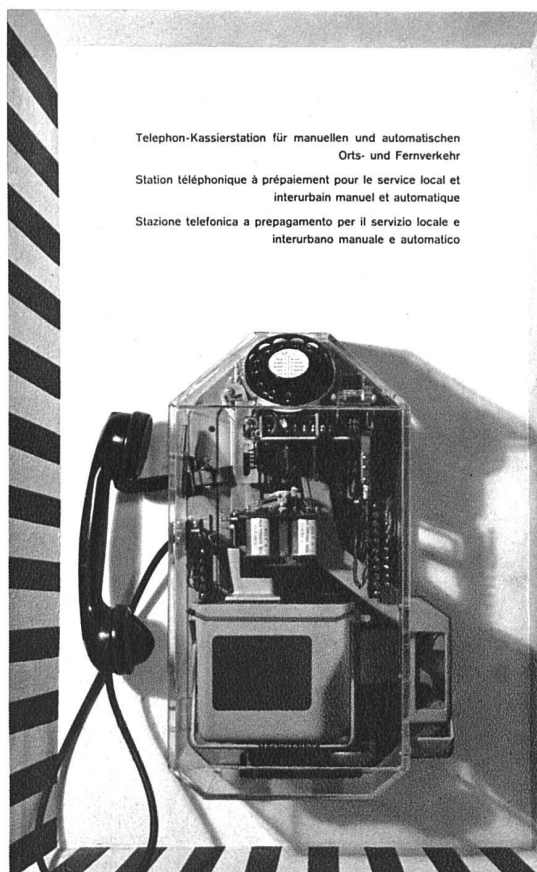
Telephonautomat in Glasgehäuse Cabine téléphonique à parois transparentes «Post, Telephon, Telegraph PTT»
