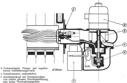
Tansiduherkopf mit Zerstäuberdüse von relativ grosser Durchlassöffnung, also keine Verstopfungsgefahr
