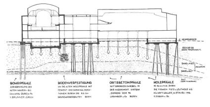
Schema der Herstellung eines Ortbetonpfahles System «Express»
