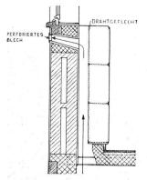
Entlüftung der Schrankfächer im Korridor, Schnitt 1:50
