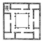
Grundrisse eines einfachen marokkanischen Hauses links Erdgeschoss, rechts Obergeschoss In beiden Geschossen offene Galerie um den Brunnenhof
