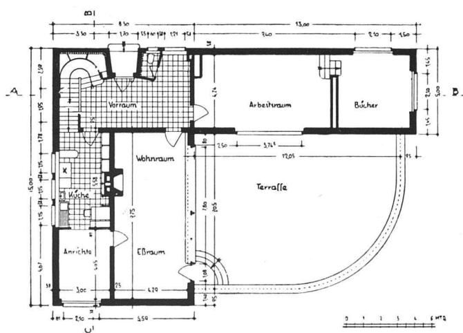
Kellermauern aus Beton, sämtliche Böden und das flache Dach aus armiertem Beton; Fassadenmauern aus Ziegelmauerwerk, 39 cm stark, beidseitig verputzt; Innenmauern 25 und 12 cm stark. Dünne Mauern sind prinzipiell vermieden worden. Sämtliche Fenster und Türen im Innern wie im Äussern haben eiserne Zargen, die im Baufortschritt in die Mauer eingelassen wurden. Der Wärme-Isolation des Hauses wurde die grösste Aufmerksamkeit geschenkt.
