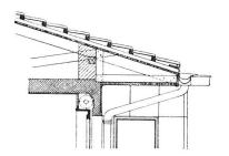
Schnitt 1:60 durch die Fassadenwand
