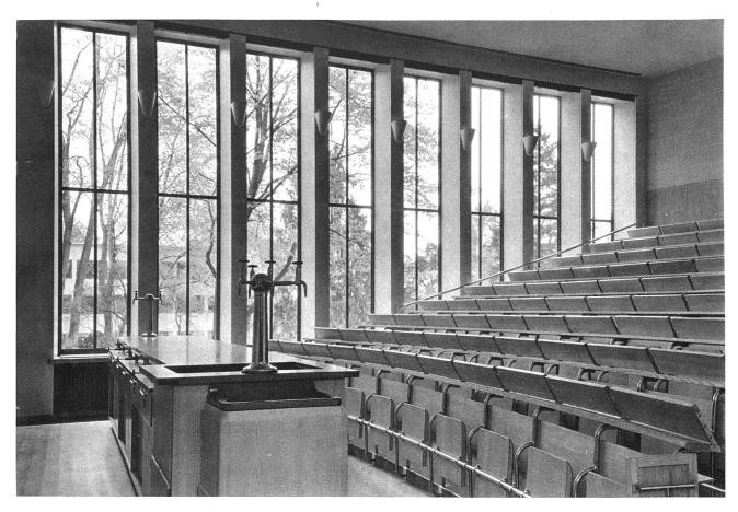
Auditorium, mit Gestühl in Eschenholz und Antikorodaltragwerk. Druckknopfsteuerung für Verdunkelung und Tafeln. Demonstrationstisch mit reicher technischer Ausstattung. Beleuchtung durch Deckenstrahlung an den Fensterpfeilern
