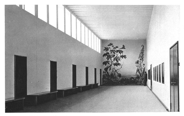
Halle im 1. Stock des Direktionstraktes mit Türen zu den Büros, Sitzungssaal und Auditorium. Material: Wände in weissem Hartstuck, Rippendecke in Sichtbeton. Boden mit Velourbelag. Heizung unter den Sitzbänken. Beleuchtung: Indirekt durch Strahler, die in den Fensterbrüstungen versenkt sind
