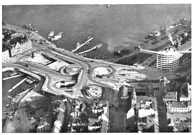
Stockholm, Schleuse («Slussen»). Scheide des Binnenwassers vom Salzwasser (Höhenunterschied ca. 3 m). Verbindungsknoten der Altstadt mit den neuesten Stadtteilen. Kreuzung der Schiffahrtslinie, Eisenbahn, Strassenbahn, Automobilstrasse und Fussgängerweg. Konstruktion: sogenannte Kleeblattform (Cloverkaparrangement). Architekt: Tage Wiliam Olsson
