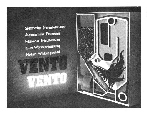
VENTO-Kessel für halbautomatischen Betrieb mit feinkörnigem Anthrazit, für Leistungen von 65 000 bis 1 200 000 Cal/h.
