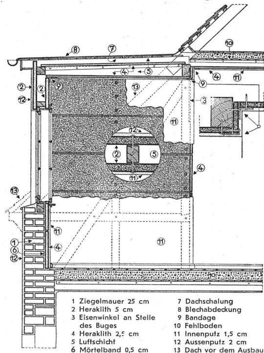
1. Durch Ausbau von Dachböden mit den hochisolierenden Heraklithplatten wird neuer wertvoller Wohnraum geschaffen.
