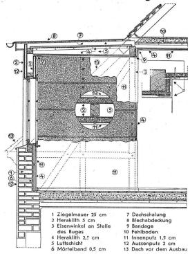
Durch Ausbau von Dachböden mit den hochisolierenden Heraklithplatten wird neuer wertvoller Wohnraum geschaffen.
