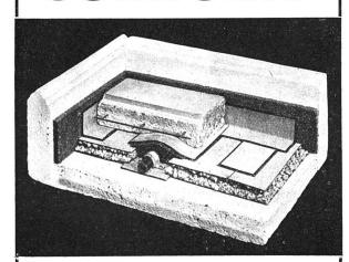
KORKMATTE FÜR SCHALLISOLIERUNG
