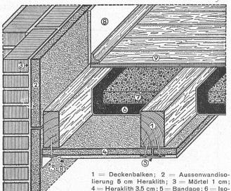
1 = Deckenbalken; 2 = Aussenwandisolierung 5 cm Heraklith; 3 = Mörtel 1 cm; 4 = Heraklith 3,5 cm; 5 = Bandage; 6 = Isolierpappe, seitlich angenagelt; 7 = Asche oder Bims, 5-7 cm hoch; 8 = Deckenund Wandputz 1,5 cm; 9 = Holzfussboden.
