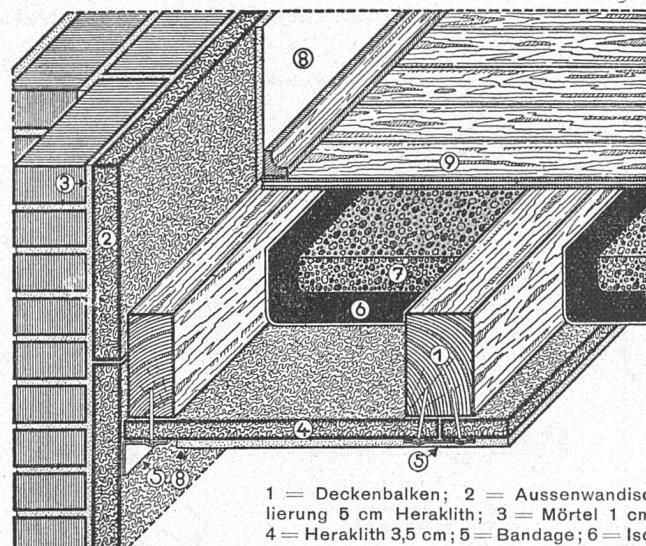
1 = Deckenbalken; 2 = Aussenwandisolierung 5 cm Heraklith; 3 = Mörtel 1 cm; 4 = Heraklith 3,5 cm; 5 = Bandage; 6 = Isolierpappe, seitlich angenagelt; 7 = Asche oder Bims, 5-7 cm hoch; 8 = Decken- und Wandputz 1,5 cm; 9 = Holzfussboden.
