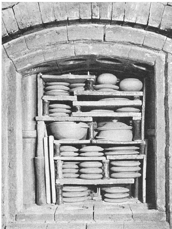
Die fertiggeformten, lufttrockenen Gegenstände zum Erstbrand (Verglühbrand) im Brennofen eingesetzt. Nach diesem Brand können die Tonwaren nicht mehr mit Wasser aufgeweicht werden
