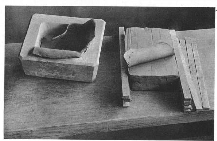
Tiefere Gegenstände müssen eingeformt oder gegossen werden
