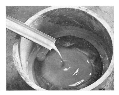
Der aufgeschlämmte Ton wird durch ein feines Sieb gelassen, um ihn von Verunreinigungen zu trennen
