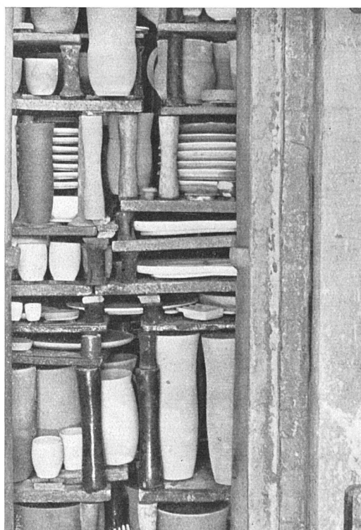
Zum Glattbrand fertig in den Ofen eingesetzte Ware
