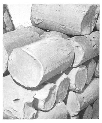
Der fertige, wieder entwässerte Ton wird gelagert
