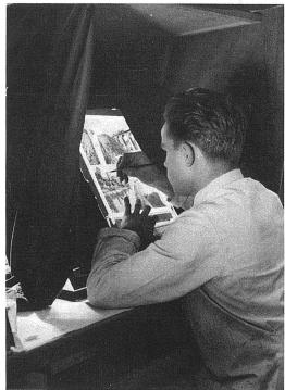
Der Fotograf beim Einsetzen einer Kassette in die Reproduktionskamera zur Anfertigung der Tiefdruckdiapositive.
