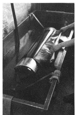
Das Kopierpapier wird wieder abgezogen, die belichtete Gelatineschicht bleibt auf dem Zylinder zurück (ein Vorgang wie bei Abziehbildern).
