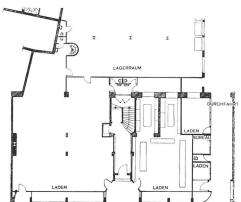
Umbau eines bestehenden Gebäudes. Fenstereinteilung von Erdgeschoss und I. Stock neu, in den zwei oberen Geschossen sind die alten Öffnungen beibehalten. Im I. Stock befinden sich die Büro des Städtischen Wohnungsamtes. Die Obergeschosse sind im Parterre mittels einbetonierten Eisenträgern abgefangen. Die äussere Fassadenverkleidung besteht aus Berner Sandstein.
