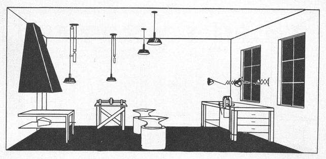
Zweckmässig beleuchtete Schmiede. Die beiden Flachstrahler für die Allgemeinbeleuchtung ergeben durch ihre Anordnung bevorzugtes Licht auf die Ambosse. Besondere Arbeitsplatzleuchten über Werkbank, Schleifmaschine und Esse
