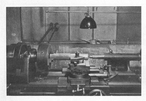
Gute Beleuchtung einer Drehbank durch kleinen Tiefstrahler. Dieses Modell eignet sich zur Beleuchtung aller Arbeitsplätze von nicht zu grosser Fläche
