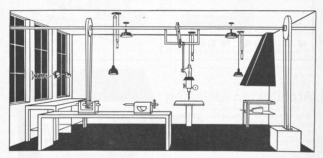
Wie eine mechanische Werkstätte beleuchtet werden soll. Die Flachstrahler für die Allgemeinbeleuchtung sind so hoch aufzuhängen, dass sie noch genügend Licht zur Kontrolle der Transmissionen ergeben. Ueber jedem Arbeitsplatz angepasste Sonderleuchten
