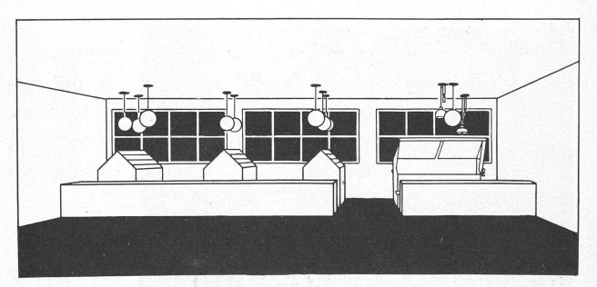
Beleuchtung einer Setzerei. Die Verwendung von Kugeln oder anderen gleichförmig strahlenden Leuchten bedingt helle Wände und Decken Zwei Platzleuchten an der Setzmaschine, vorn über der Tastatur, hinten zur Kontrolle der Typen in den Kanälen
