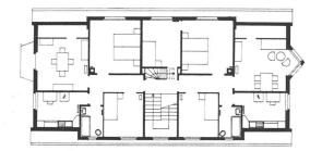
54 Dreizimmer- und 58 Vierzimmerwohnungen, total 112 Wohnungen in einem einfachen und 18 Doppelhäusern mit vollständig ausgebautem Dachgeschoss, wie dies vom veralteten Zürcher Baugesetz erzwungen wird. Gemeinsame Heizzentrale und Warmwasserversorgung. Infolge der durch die Bodenverhältnisse veranlassten verschiedenen Fundationen und Kellerhöhen variieren die Kubikmeterpreise zwischen Fr. 53.10 und Fr. 58.25. Kosten der Umgebungsarbeiten und Bepflanzung pro Wohnung ca. Fr. 1065.
