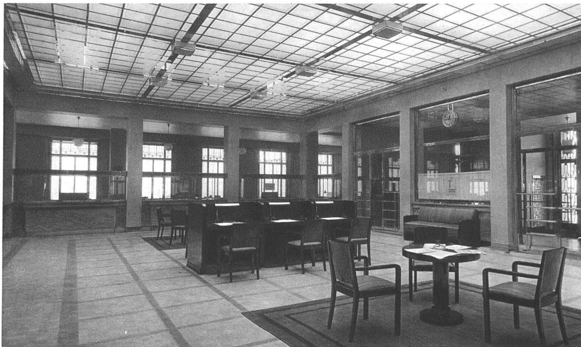
Hall central à rez-de-chaussée, 22 guichets métal blanc (Staybrite et anticorodal) bancs en marbre de Lunel
