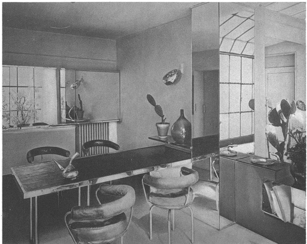
Speisezimmerecke bei Charlotte Perriand, Paris. Ausziehbarer Tisch mit verchromten Stahlstützen und seitlichem Unterbau mit Klappfach aus Stahlblech mit Duco-Anstrich, Tischplatte aus Rohglas mit Einfassung aus vernickeltem Stahl, drehbare Sessel aus verchromtem Stahl mit braunem Lederbezug
