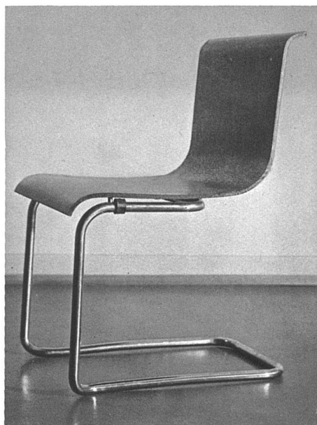
Ineinanderstellbarer Stuhl mit zu diesem Zwecke verkröpftem Stahlrohrgestell. Sitz aus in sich selbst versteifter und gebogener Sperrholzplatte gebildet. «Wohnbedarf»-Typ von Arch. A. Aalto, Finnland
