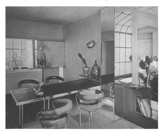
Speisezimmerecke bei Charlotte Perriand, Paris. Ausziebarer Tisch mit verchromfen Stahlstützen und seitlichem Unterbau mit Klappfach aus Stahlblech mit Duco-Anstrich, Tischplatte aus Rohglas mit Einfassung aus vernickeltem Stahl, drehbare Sessel aus verchromtem Stahl mit braunem Lederbezug
