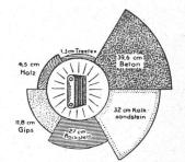
bietet den gleichen Kälte- und Wärmeschutz wie eine 27 cm Backsteinmauer; ist im Nutzeffekt und künstlerisch die ideale Verkleidung für Decken, Wände, Dachausbauten, Heizkörpernischen etc.;
