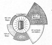
bietet den gleichen Kälte- und Wärmeschutz wie eine 27 cm Backsteinmauer; ist im Nutzeffekt und künstlerisch die ideale Verkleidung für Decken, Wände, Dachausbauten,
