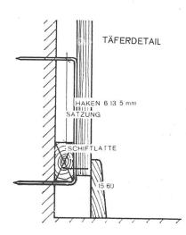
Täfer, auf einer Schiftung befestigt, die lose in den in der Strickwand befestigten Hacken gleitet, so dass die Schwindbewegungen dieser Wand nicht übertragen werden.
