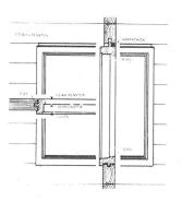
Fenster. Diese Konstruktion ermöglicht die Setzung der Strickwand, die Fuge über dem Sturz darf erst nach einigen Jahren ausgestopft werden. Das äussere Fenster wird in Anbetracht des Klimas auch im Sommer nicht ausgehängt. Gegenüber der üblichen Konstruktion mit Rahmen, Futter und Verkleidung besseres Passen, schöneres Aussehen und Wegfall der Nägel.
