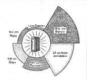
bietet den gleichen Kälte- und Wärmeschutz wie eine 27 cm Backsteinmauer; ist im Nutzeffekt und künstlerisch die ideale Verkleidung für Decken, Wände, Dachausbauten, Heizkörpernischen etc.;
