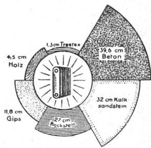
bietet den gleichen Kälte- und Wärmeschutz wie eine 27 cm Backsteinmauer;
