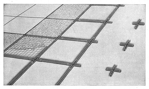
Schlussbelag, Armierung bestehend aus Verbindungsstücken und Fugenkreuzen
