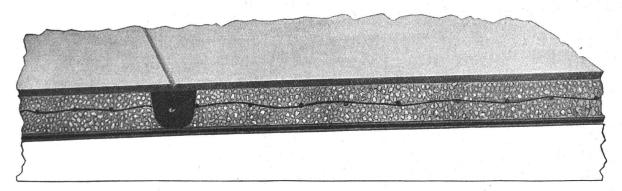
Von oben nach unten: Wasserdichter Schlussbelag mit ausgezogenen Dehnungsfugen, wasserdichter Esmeralda-Mörtel mit Armierung aus Spezialgewebe und Dehnungsfuge mit Tropical-Kittmasse K, Tropical-Grundierungs- oder Trennungsschicht, Gefällsbeton
